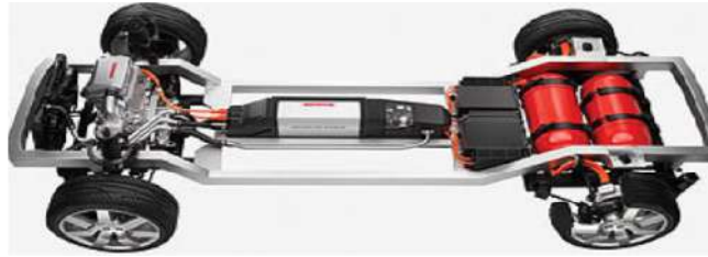
Figure III.11: Vue éclatée de la Honda FCX 2006
