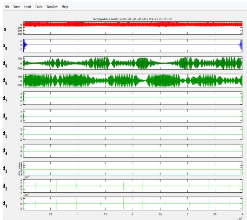
Fig. II.26 Analyse par transformation d'Ondelette continue type multi niveau de la phase Vcs en fonctionnement sain.
