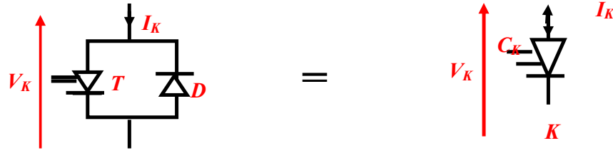
Figure (IV.3): Interrupteur bidirectionnel en courant
