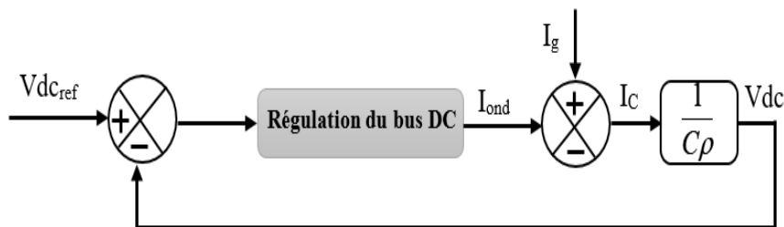
Fig. V.6. Schéma de contrôle de la tension du bus DC.
