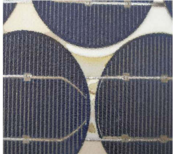
Figure III.20 Couche EVA dégradée et formation de bulles d'air entre- cellules PV.
