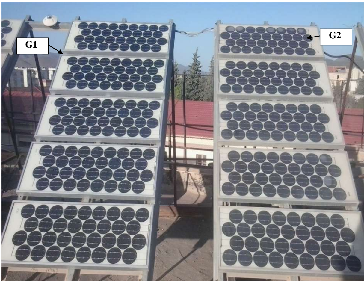
Figure. III. 21 Vue du générateur G1 et G2 testé pour déterminer le taux de dégradation et l'effet de dégradation sur la production des modules.
