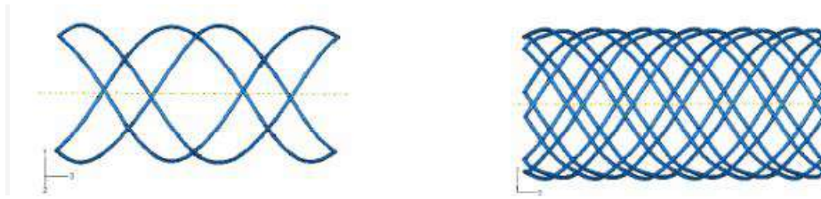
(a) Figure 1.4: Le stent design nouvellement cardiovasculaires (b). (b) stent cardiovasculaire à quatre fils. (b) de stent cardiovasculaire avec 12 fils.
