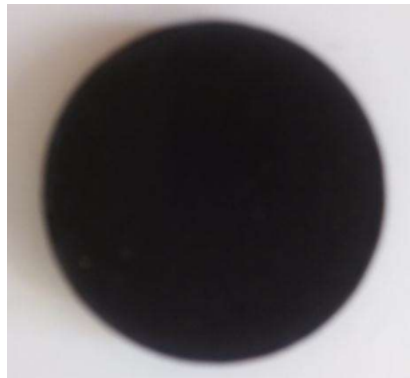
Figure 3.12: Pastille de CIGS obtenue après compactage
