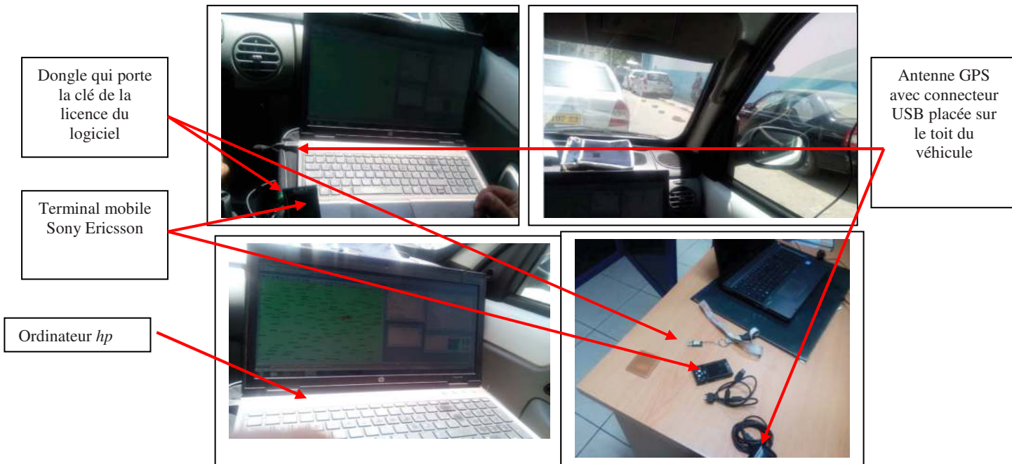
Figure IV.5: Kit des équipements utilisés pour les mesures.
