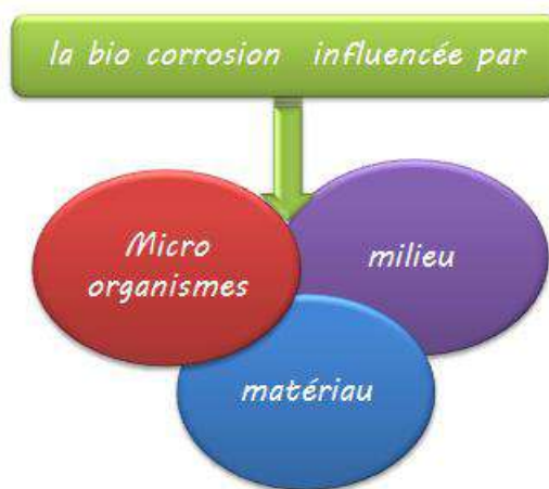
Fig. II.02 : Les 3 facteurs de la bio corrosion [57].
