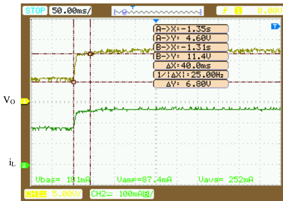
Figure IV.10 Tension de sortie et courant de l'inductance obtenus par la commande IAFS du 1 er cas.
