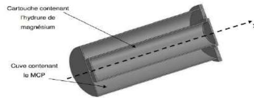
Figure 2.2 : Coupe en 3D du réservoir [13].
