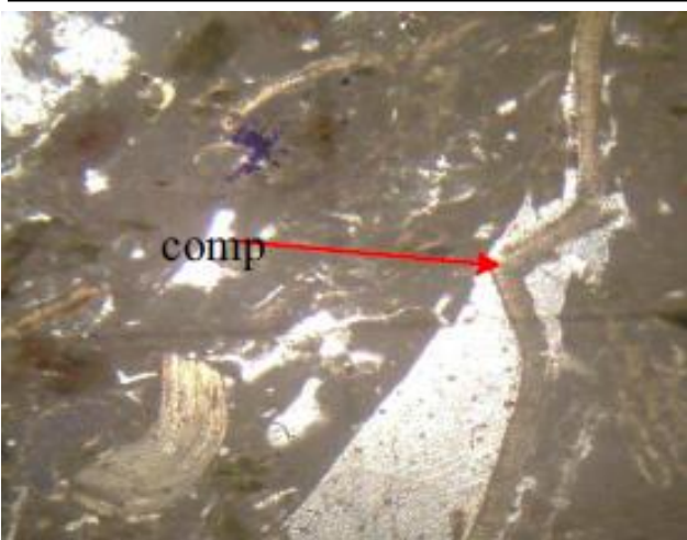
Fig.05 :Signe de compaction mécanique.
